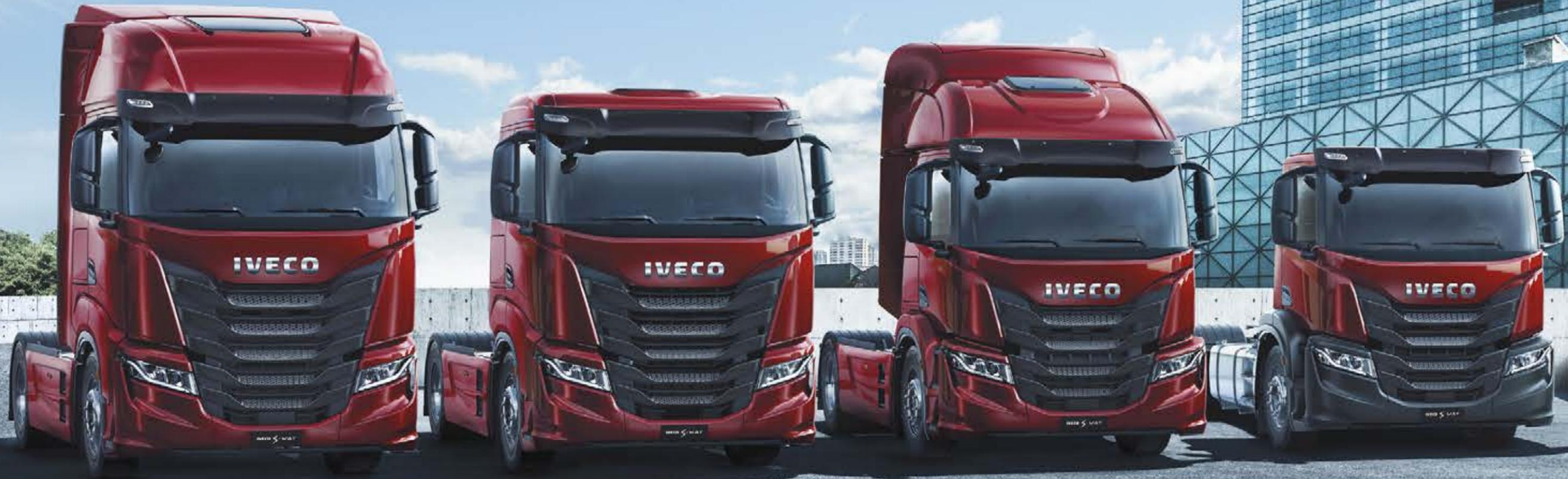
La gama de cabinas IVECO S-WAY ofrece una selección que se adapta a cada misión: la cabina ancha y larga **AS** con techo alto o techo medio, la cabina larga **AT** con techo bajo o alto y la cabina **AD** corta con techo bajo.
