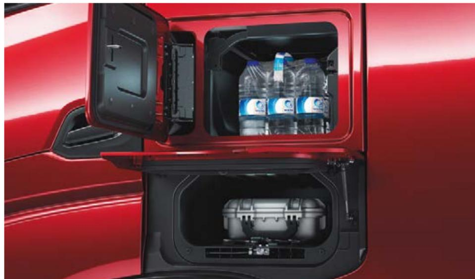
Los compartimentos exteriores ofrecen una gran capacidad de almacenaje hasta de 380 litros.
